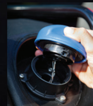
Nádrž na AdBlue® byla pečlivě umístěna tak, aby poskytovala izolaci při vysokých i nízkých teplotách. Plnění obou nádrží je bezpečné a pohodlné.
