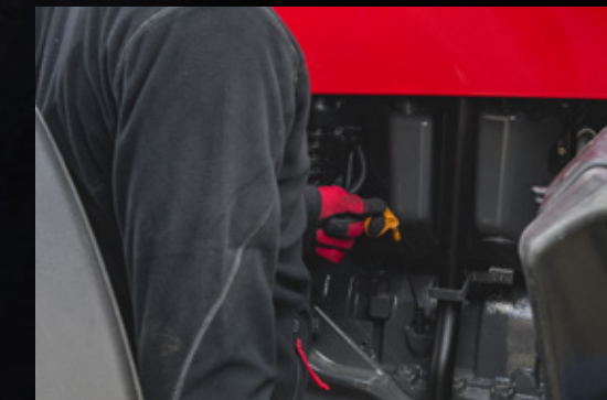
Konstrukce přední nápravy a štíhlé kapoty usnadňují přístup k měrce oleje a filtru.
